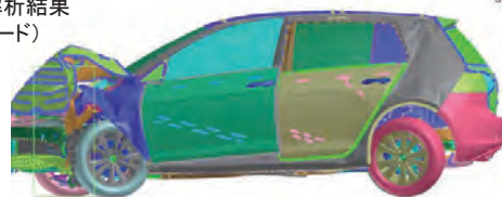
Golf 衝突解析結果 (部品荷重)ピーク値: 約170kN
